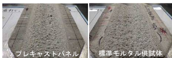
写真-18 供試体の摩耗状況
