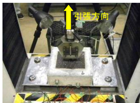
写真-14 引張付着試験
