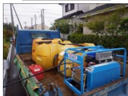
高圧洗浄機・貯水タンク
